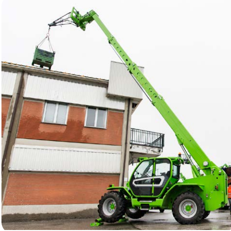
серія Panoramic винос від 12 м до 18 м вантажопідйомність до 5 т
