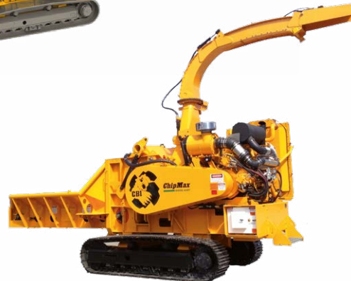
Подрібнювач деревини Chipmax 484 вага від 25100 кг до 29400 кг
