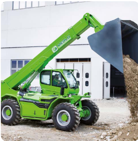
серія Heavy Duty винос від 8 м до 10 м вантажопідйомність від 5 т до 12 т
